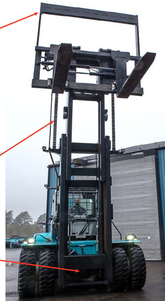
Додаткові направляючі колеса щогли та бічні опори (8 коліс + 8 опор)
